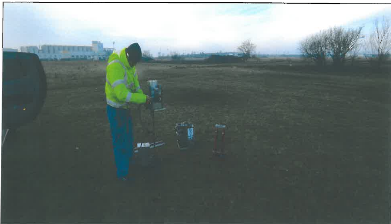
Foto – execuția încercării de penetrare dinamică medie – zona forajului F 3 ;
